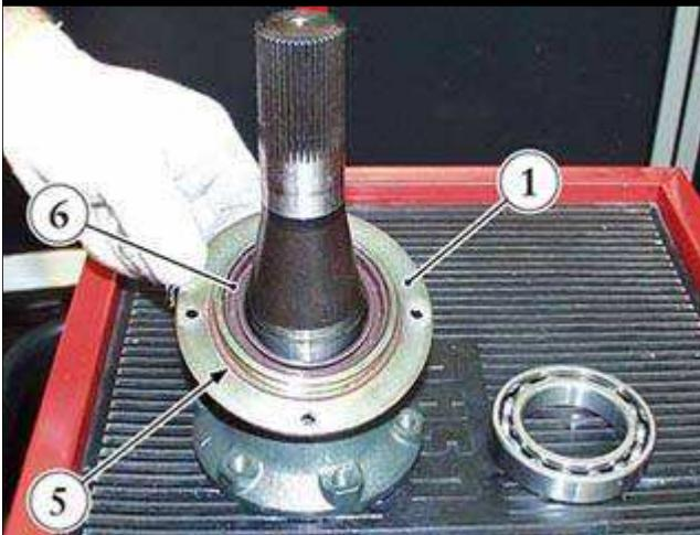
● 拆卸盖(1)，连同外部O形圈(5)和内部密封圈(6)。
