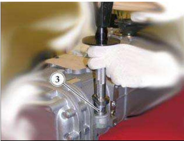
● 将工具靠到衬套右侧并使用锤子将衬套 (3) 打入其底座中。
