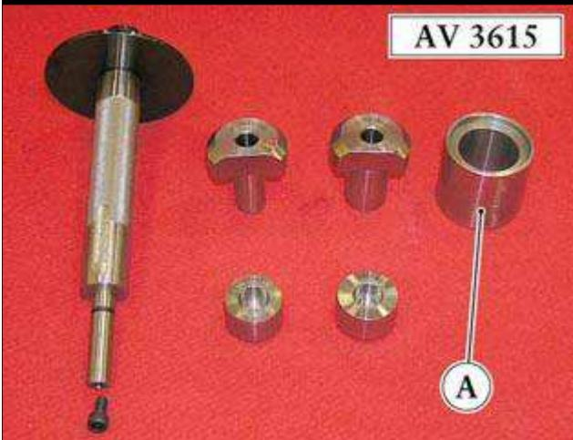
在该操作中，必须使用专用拉拔工具 (AV 3615)，它包含用于不同衬套直径和垫圈 (A) 的附件。
