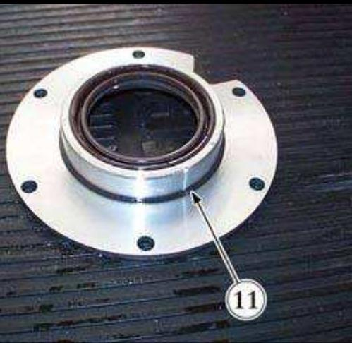
● 检查并确认盖上的 O 形圈 (11) 处于良好状况, 然后使用变速箱油润滑法兰轴。
