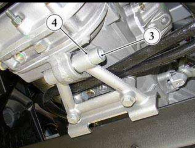
● 自变速箱 297 起, 装配外径为 32 mm、内径为 17 mm 的衬套, 以容纳带有垫圈 (4) 的新紧固螺钉 (3)。
