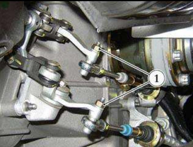
● 通过松开枢轴螺钉上的螺母 (1) 从操纵杆分离控制拉线端子。
