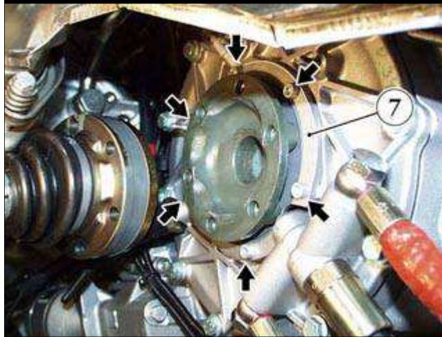
● 拧下将外部盖 (7) 固定到变速箱壳体的六个螺钉。
